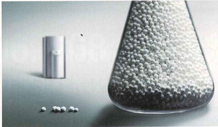
Zeolithe sind Minerale, die Wasser aufnehmen und bei Erhitzung wieder abgeben. Der eingesetzte Zeolith der erdgasbetriebenen Solarwärmepumpe wird für Vaillant synthetisch hergestellt.
