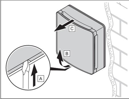
3. Irrota puhallinyksikkö sekä tuulensuoja ja etusuojuus.
