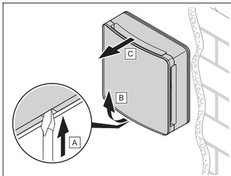
3. Desmonte a unidade de ventilador com a proteção contra vento e a guarnição dianteira.
