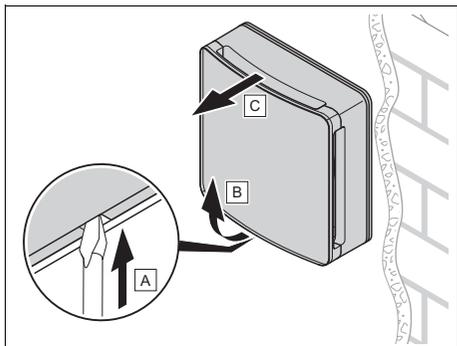
3. 请拆卸风机单元及防风装置和前挡板。
