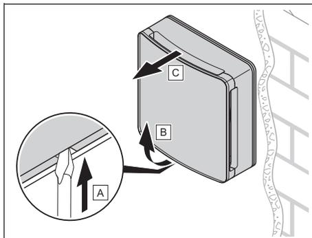
3. Smontare l'unità di ventilazione con la protezione antivento ed il rivestimento anteriore.
