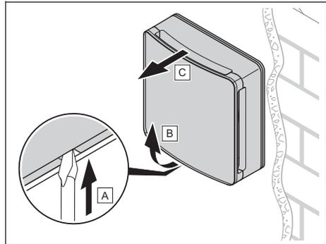
3. Demontieren Sie die Lüftereinheit mit Windschutz und Frontblende.
