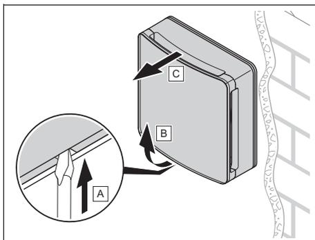
3. Demontujte jednotku ventilátora s ochranou proti vetru a čelným krytom.
